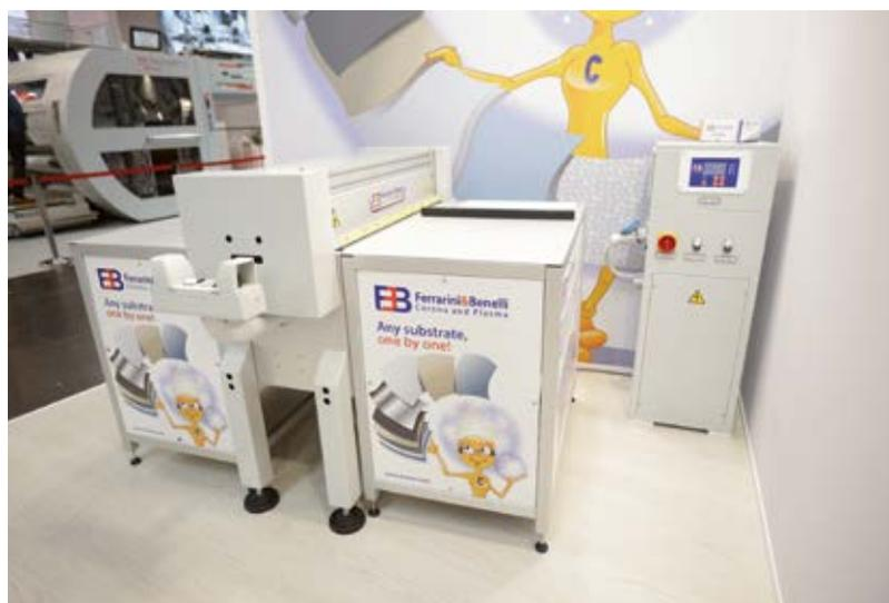
Format è il sistema di trattamento ideale per applicazioni da laboratorio, cartotecnica e stampa digitale e serigrafica. La macchina può essere utilizzata come soluzione stand-alone con sistema di trascinamento fogli comandato da motore oppure inserita in una linea di produzione.
